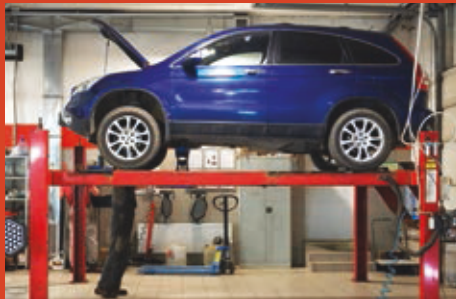
Bij een brug op hoogte is het niet toegestaan in de auto te zitten of te klimmen.
